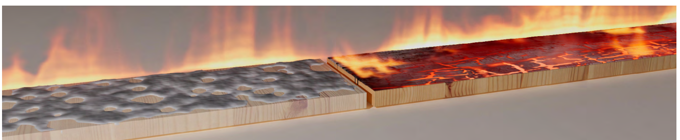
Isolierende Schaumschicht (links), die sich durch ein Feuer entwickelt und das beschichtete Holzbauteil (schwer entflammbar) zeitweise vor einer sofortigen Entzündung (rechts) schützt.
