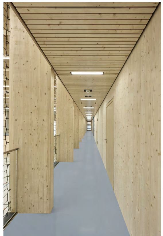
HENSOTHERM® 1 KS INNEN zum Schutz der Deckenverkleidung aus Holz in Fluren, die im Brandfall als Fluchtwege dienen.
