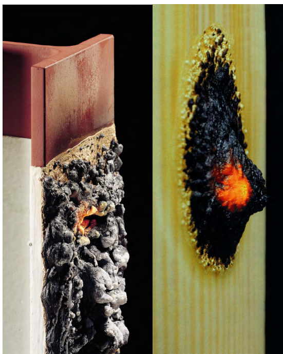
Brandschutzwirkung von HENSOTHERM® Stahl- bzw. Holzbrandschutzsystemen
